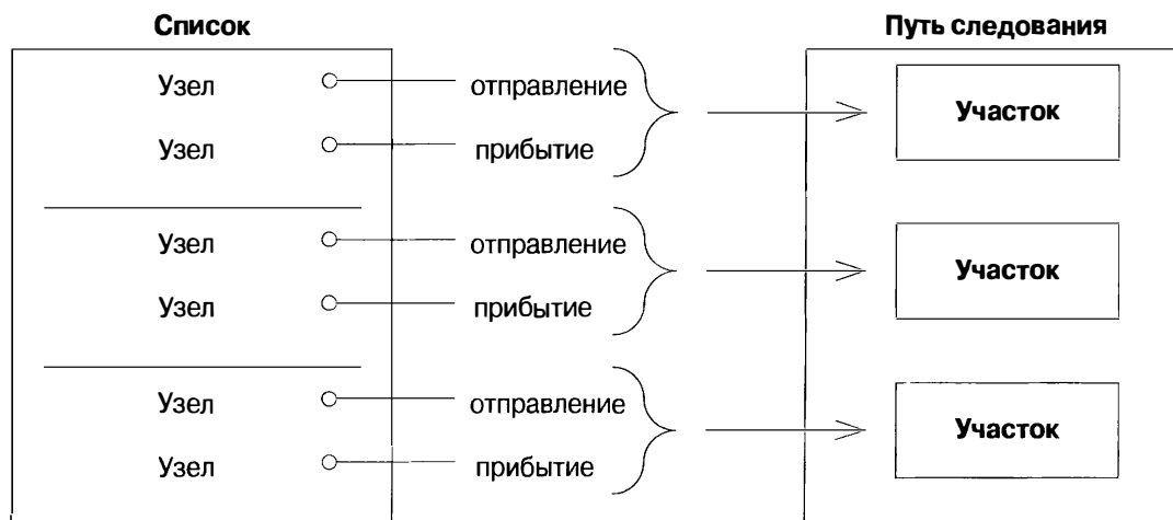
Рис. 14.5. Трансляция маршрута, найденного Службой трассировки по транспортной сети (Network Traversal Service)
